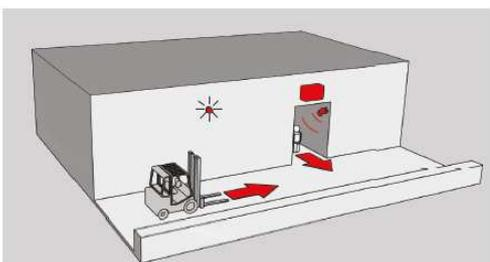
Le conducteur du véhicule sur l'allée principale est alerté de la présence de piétons arrivant d'une entrée latérale. Le passage du piéton devient plus sûr. La figure montre une configuration minimale (1 unité de commande, 1 capteur, 1 dispositif de signalisation).
