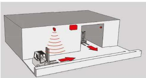
La présence d'un chariot élévateur se déplaçant sur l'allée centrale active le signal sonore / lumineux ayant pour but d'alerter le véhicule ou l'opérateur venant de l'allée latérale ou d'une porte.
